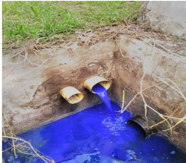
En las pruebas de flujo de los pisos superiores se comprobó que los apartamentos del piso 2 al piso 12 se conectan al colector de 4” pvc-s.
